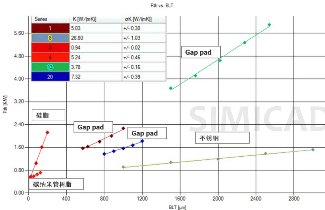
通过改变热界面材料的厚度，可以有效地屏蔽接触热阻对测试结果的影响。
