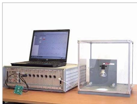
将 LED 灯具放置到 JEDEC 规定的一立方英尺的标准静止空气箱中，利用 T3Ster 进行热瞬态测试。
