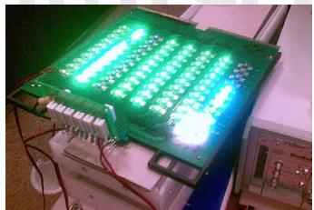
测量状态：35V @ 350mA 测量电流
